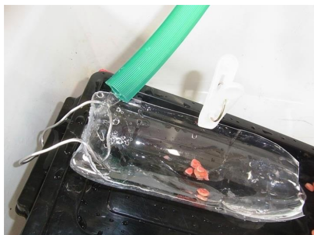
直接試料に衝突しないよう流水洗浄を開始
