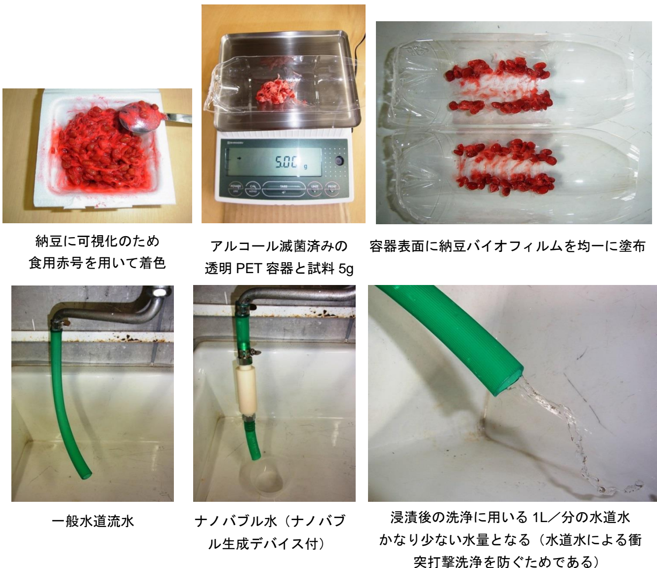
図 1：ナノバブル水のバイオフィーム除去能確認試験の試験環境
