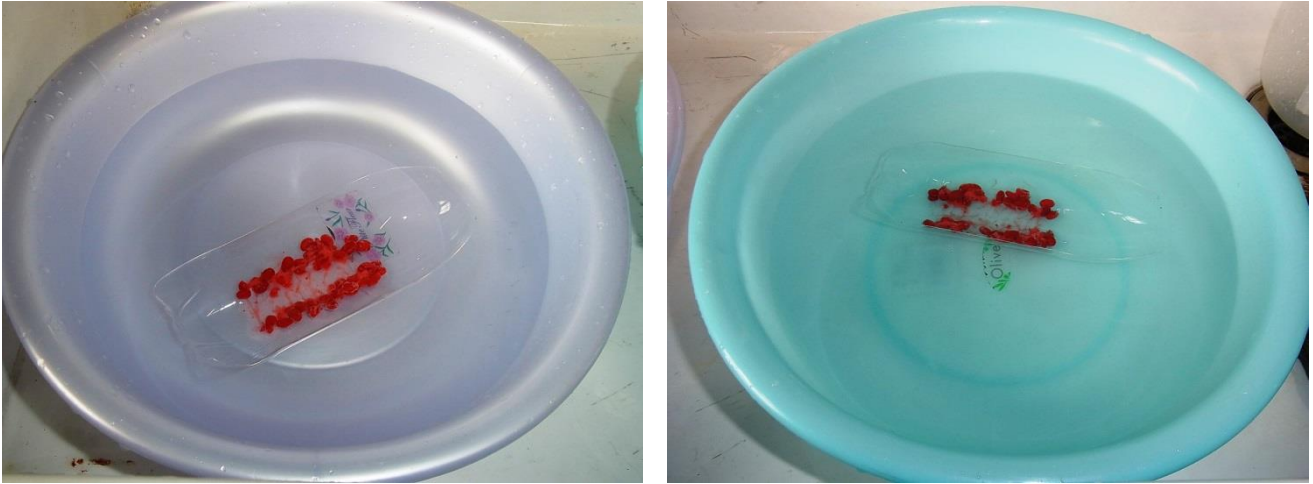
図2 2つの試料を別々にナノバブル水と一般水道流水とに1時間浸す（左：ナノバブル）
